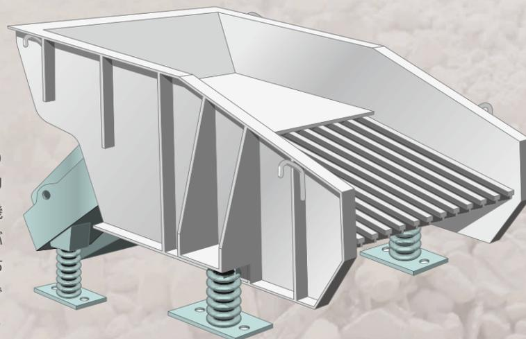
振動モータをトラフに直接取付けた強制振動タイプ。構造上、軽量かつ堅牢。またトラフへの振動伝達効率がよく、材料の付着による振幅増大現象がないため、稼働がきわめて安定しています。
