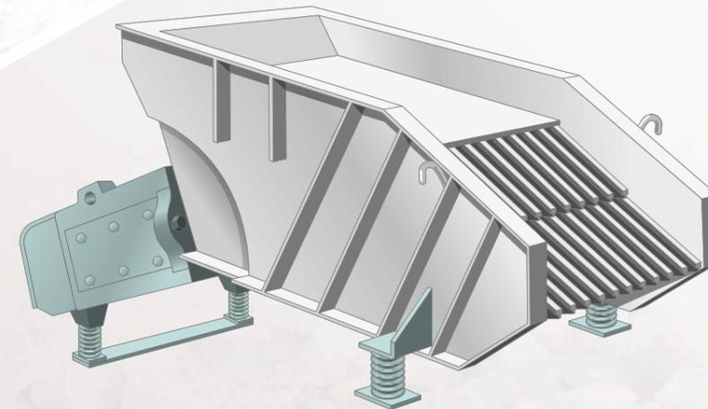
電磁石による振動と板ばねの共振作用を利用した振動機です。ふるい効率が抜群で、鉱石、碎石、石灰など大容量の粗ぶりを高能率で行います。処理量は自由に調整できます。過酷な使用にビクともしない堅牢構造。
