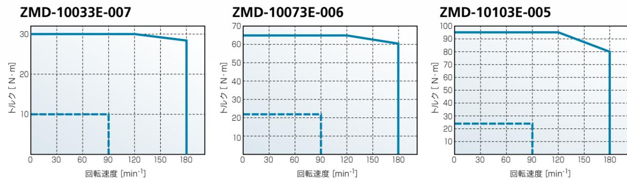
\*モータ特性を規定する 主回路電源電圧はAC200Vとします
