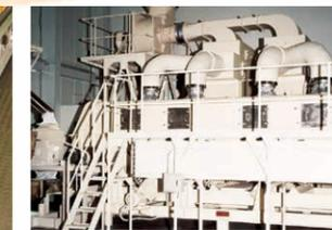
食品材料乾燥冷却用BMコンベヤ
