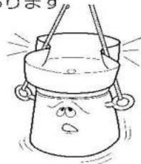
**C** 固定フレーム以外で持ち上げないでください。板パネの変形や破損の原因になります。
