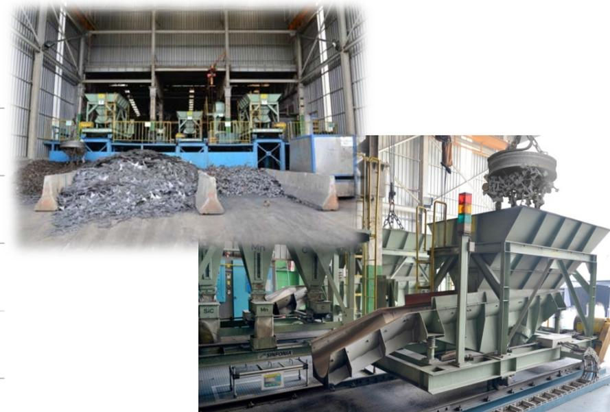
鋳物原料自動投入装置（リフマグと振動機の組合せ）
