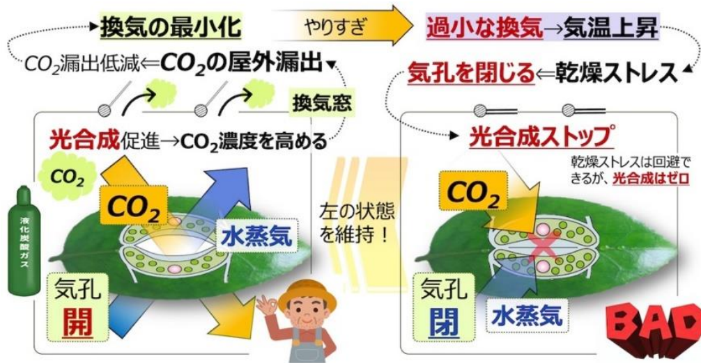
図2 セミクローズド温室の環境制御において光合成速度を高い水準に保つために考慮すべき生体情報とその位置付け
