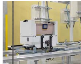
病院内搬送システム
