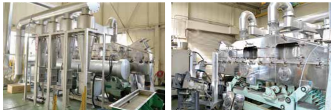
振動乾燥・冷却実験設備
