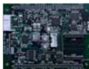
IoTシステム構築用マイコンボードです。拡張ポートに無線モジュール(2.4GHz/920MHz)を装着可能で、マイコンはLPC1124を採用。無電圧接点入力、オープンコレクタ出力、アナログ入力、RS-485半二重通信をサポート。5~24Vのワイド電源に対応できます。
