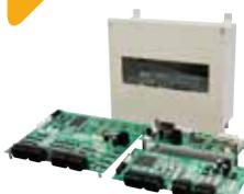
建設機械の要件である高い耐環境性、CAN通信、J1939プロトコル※を搭載したコントローラで、一般的なI/Oだけでなくシリアル通信、USB、SDカード等の回路も搭載しています。
